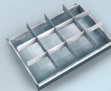
Schubladenunterteilung 54E x 36E teilt die Schublade in 12 Teile auf, besteht aus 3 Lochblechen 36E, 6 Trennblechen 14E und 2 Trennblechen 12E.
